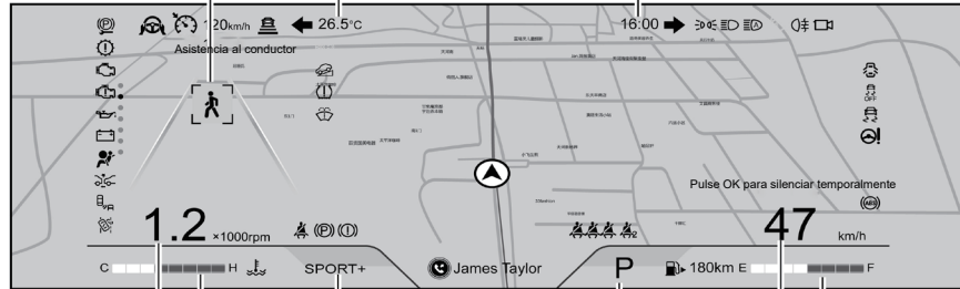
① Pantalla de instrumentos combinados ② Visualización de la temperatura exterior ③ Visualización de la hora ④ Medidor de combustibles ⑤ Velocímetro ⑥ Visualización de marcha ⑦ Modo de conducción ⑧ Indicador de temperatura del refrigerante del motor ⑨ Tacómetro
